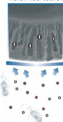
Sezione fibra cava Hollow fiber section
